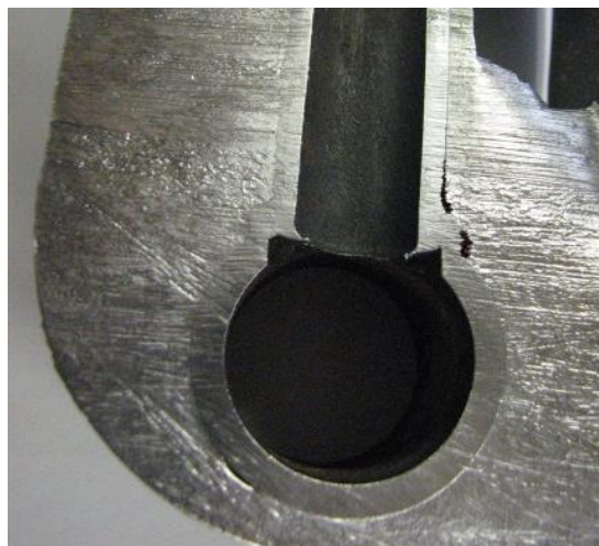
Рис. 1. Порожнина між елементами біметалевого виливка
