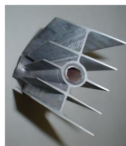
Рис. 2. Біметалевий виливок «секція радіатора опалення»: a – зовнішній вигляд та сталеві вставки; б – переріз
