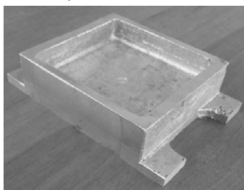
Рис. 6.6. Отливка «корпус», сплав Д16 ГОСТ 4784-97
