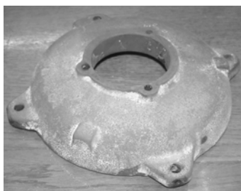
Рис. 6.7. Отливка «крышка», чугун СЧ20 ГОСТ 1412-85
