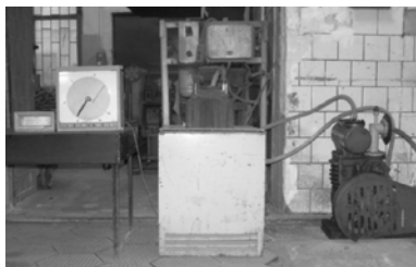
Рис. 6.5. Установка для заливки низкотемпературных форм с противопригарными покрытиями под низким давлением
