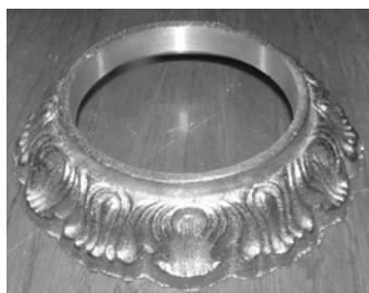
Рис. 6.9. Отливка «корпус часов», сплав БрО6Ц6С2Х ГОСТ 614-97
