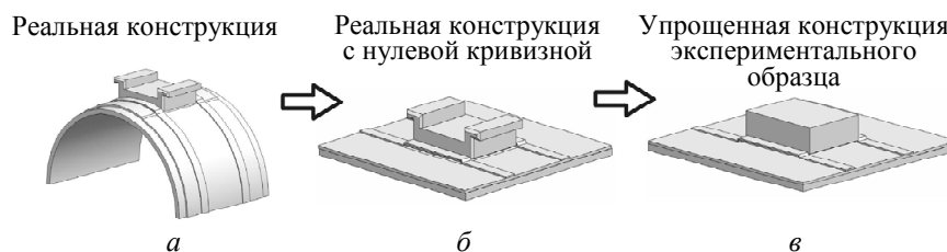
Рис. 1. Анализ упрощения формы реальной конструкции до экспериментального образца
