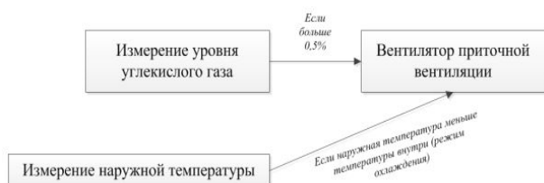
Рис. 2. Использование вентилятора приточной вентиляции
