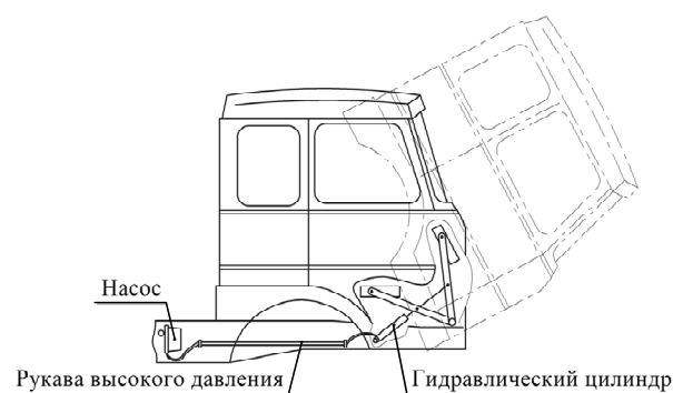
Рис. 1. Схема расположения элементов гидравлического механизма подъема кабины
