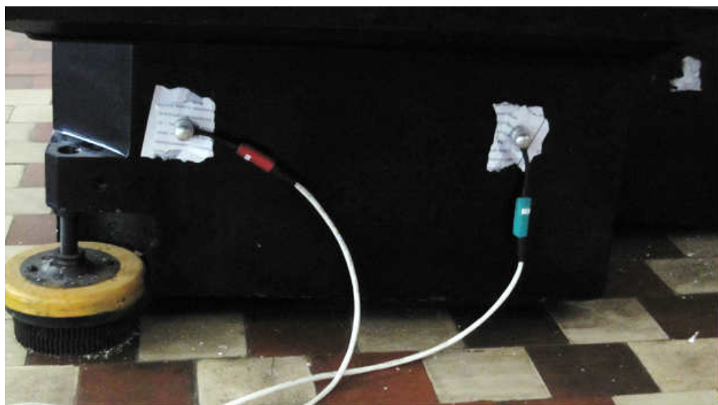
Рисунок 3.6 – Розташування п’єзоелектричних датчиків під час дослідження дисипативних характеристик матеріалу у готовому виробі
