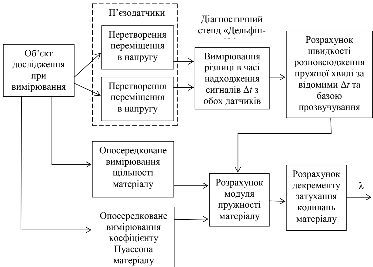
Рисунок 4.5 – Блок-схема перетворень вимірюваної величини в акустичному методі вимірювання дисипативних властивостей неметалевих гетерогенних матеріалів
