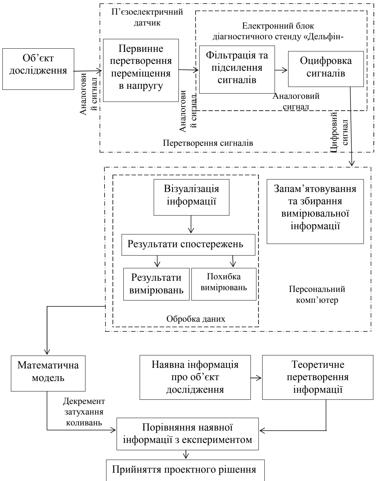
Рисунок 4.1 – Структурна схема вимірювальної системи для визначення декременту затухання коливаний в неметалевих гетерогенних матеріалах
