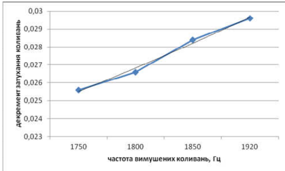
Рисунок 3.11 – Залежність декременту затухання коливань від частоти
