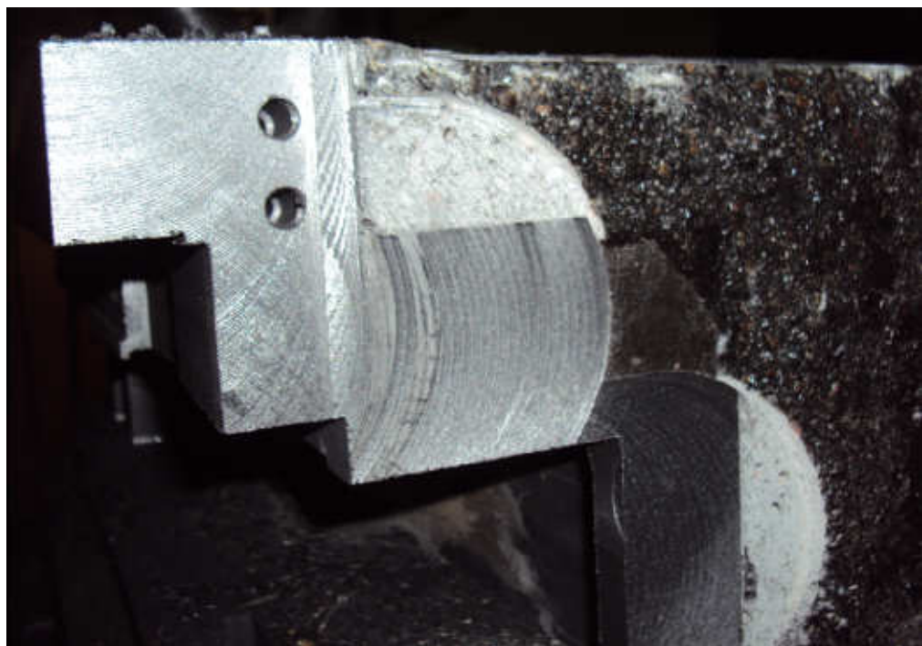
Рисунок 1.4 – Фрагмент станини із синтеграну з чавунними закладними
