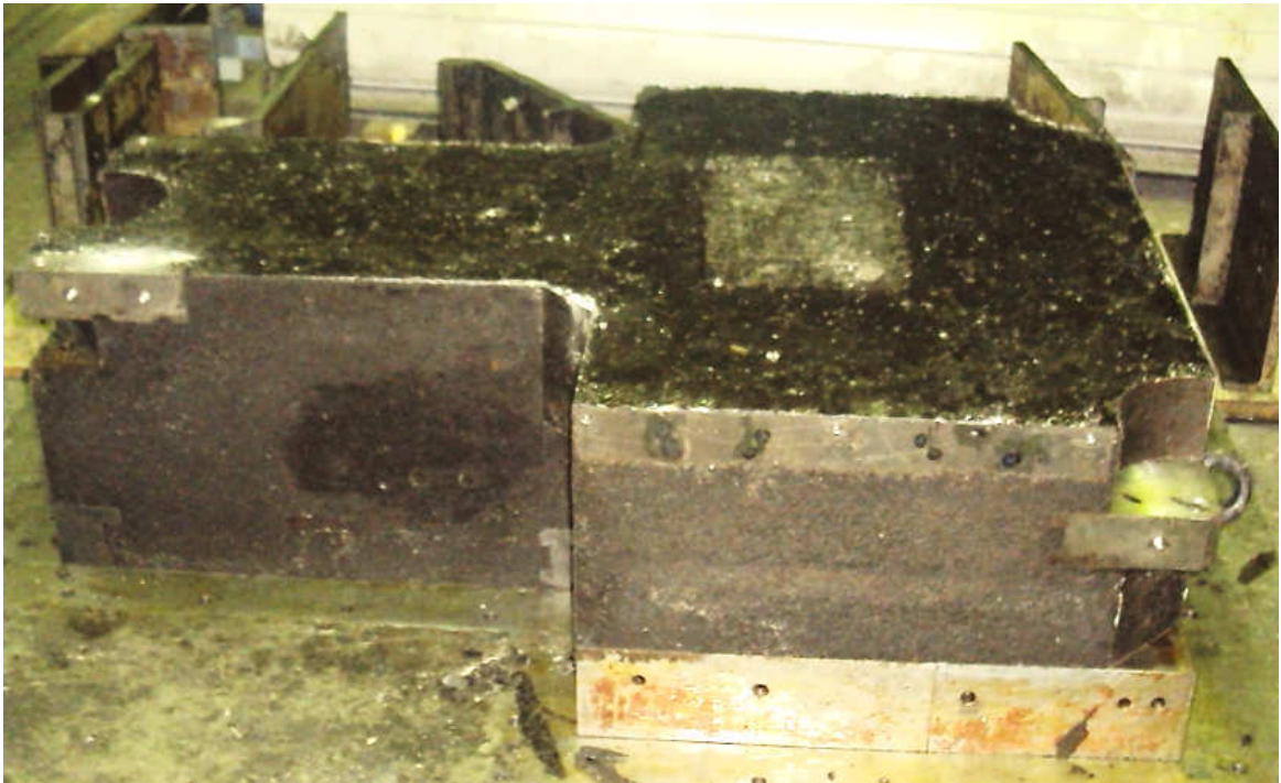
Рисунок 1.3 – Основа універсального фрезерного верстата ОММ із синтеграну після виймання з форми фірми ХК Мікрон
