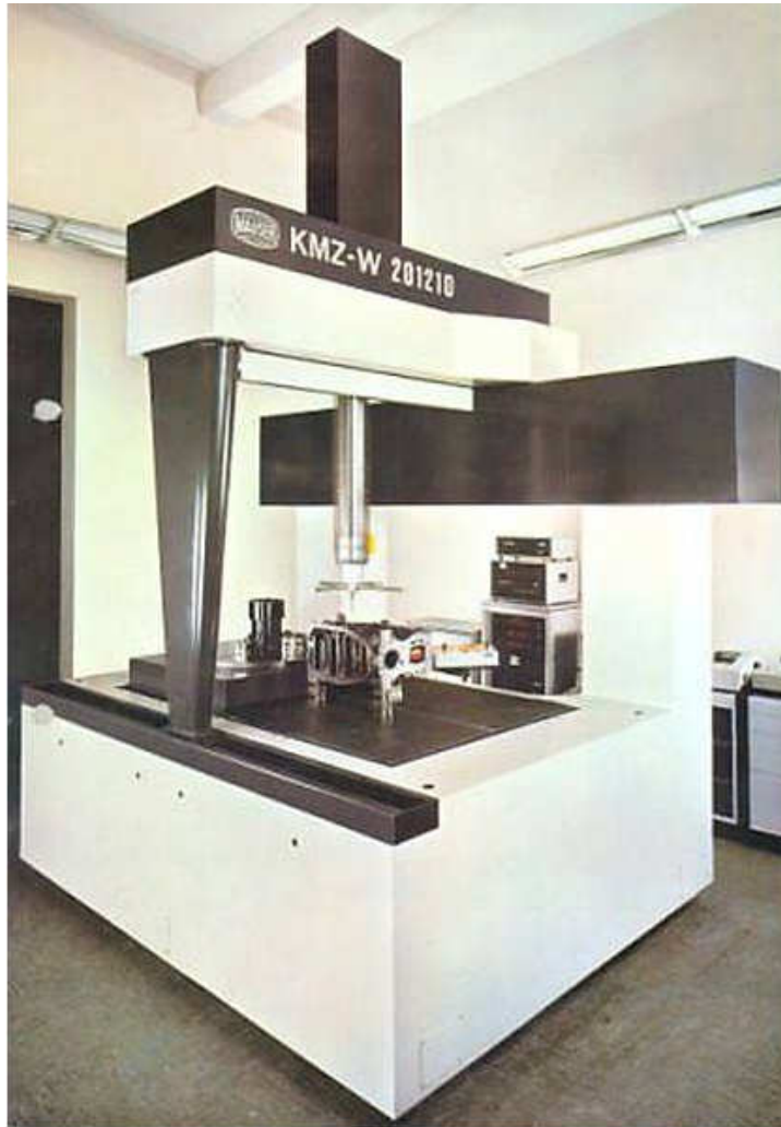
Рисунок 1.6 – Координатно-вимірювальний центр KMZ – W 20-12-10
