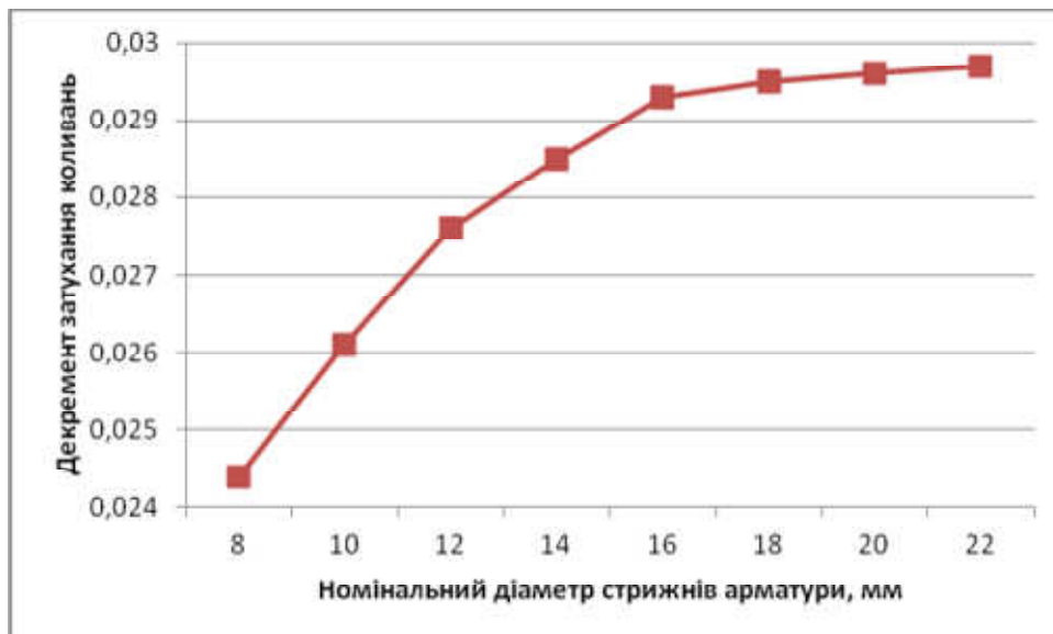
Рисунок 4.8 – Залежність декременту затухання коливань в зразках із синтеграну від номінального діаметру анкерів закладних деталей у вигляді стрижнів арматури періодичного профілю
