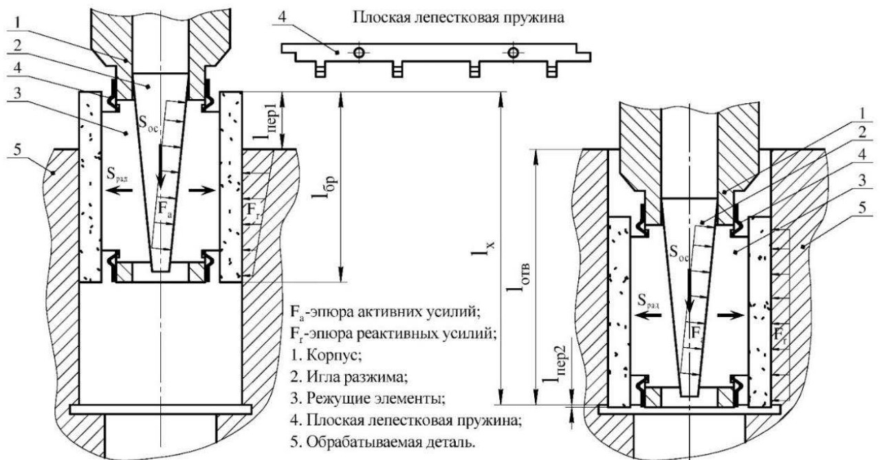
Рис. 1.7. Конструктивная схема инструмента для хонингования глухих отверстий
