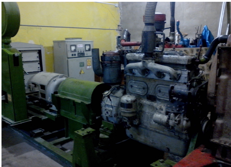
Рисунок 2-Загальний вигляд випробувального стенду з дизельним двигуном СМД-17 та електричною машиною АКБ-82-6УЗ.
