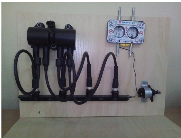
Рис. 4. Загальний вигляд стану для дослідження системи запалювання для мікропроцесорної системи впорскування палива
