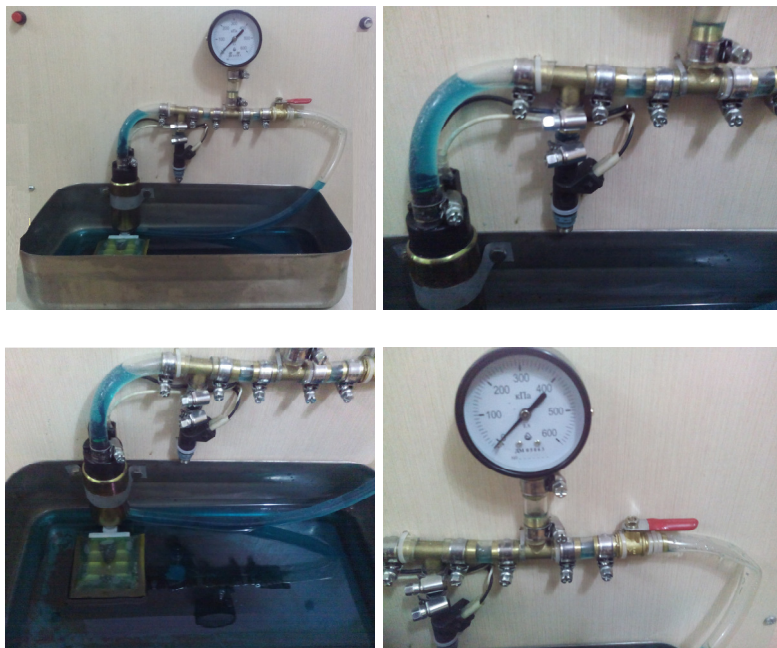
Рис. 2. Зовнішній вигляд окремих частин стану для дослідження системи впорскування палива
