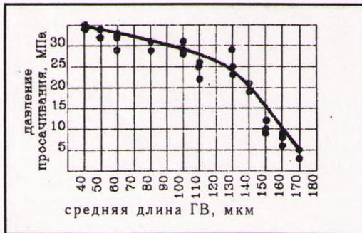
Рис. 4. Зависимость давления просачивания от средней длины ГВ
