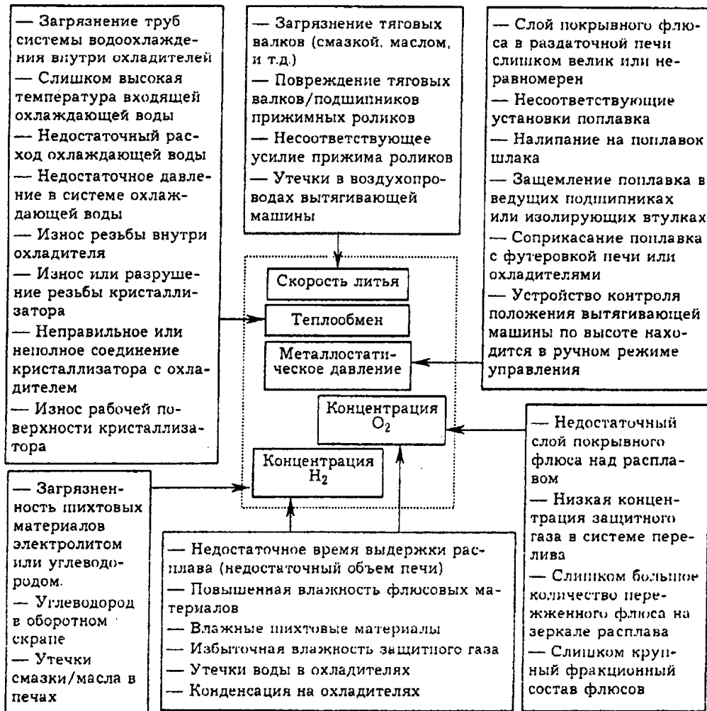
Рис. 3. Факторы, влияющие на технологические параметры процесса
