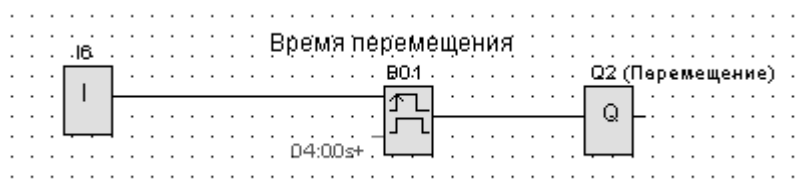
Рис. 2. Программа, обеспечивающая перемещение по одной оси с использованием функции интервального реле времени
