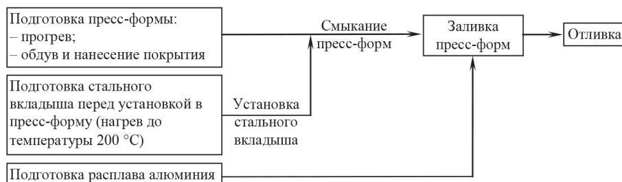
Рис. 1. Схема технологического процесса литья под давлением биметаллических отливок
