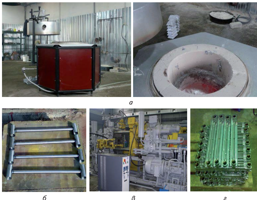
Рис. 3. Стадии процесса литья биметаллических отливок: а — общий вид печи сопротивления САТ-0,16; б — стальные вкладки; в — машина ЛПД; г — секции радиатора
