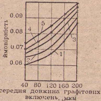
Рисунок 1 - Залежність вірогідності виникнення транзитної пори від середньої довжини включення
