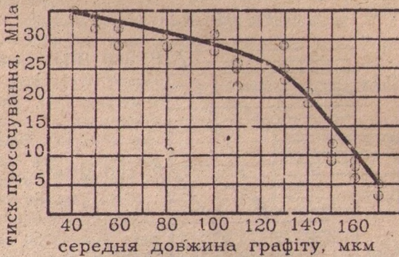
Рисунок 4 - Залежність тиску просочування від довжини графітового включення
