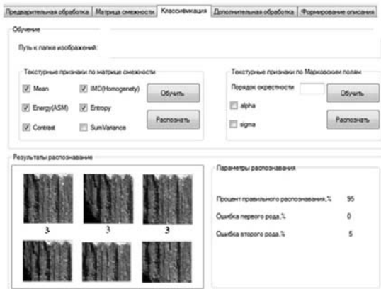
Рисунок 5 – Изображение одной из рабочих панелей программного комплекса для комплексного распознавания классов текстур инструментов
