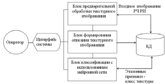
Рисунок 2 – Фрагмент интеллектуальной системы распознавания классов текстур зон износа РЧ РИ
