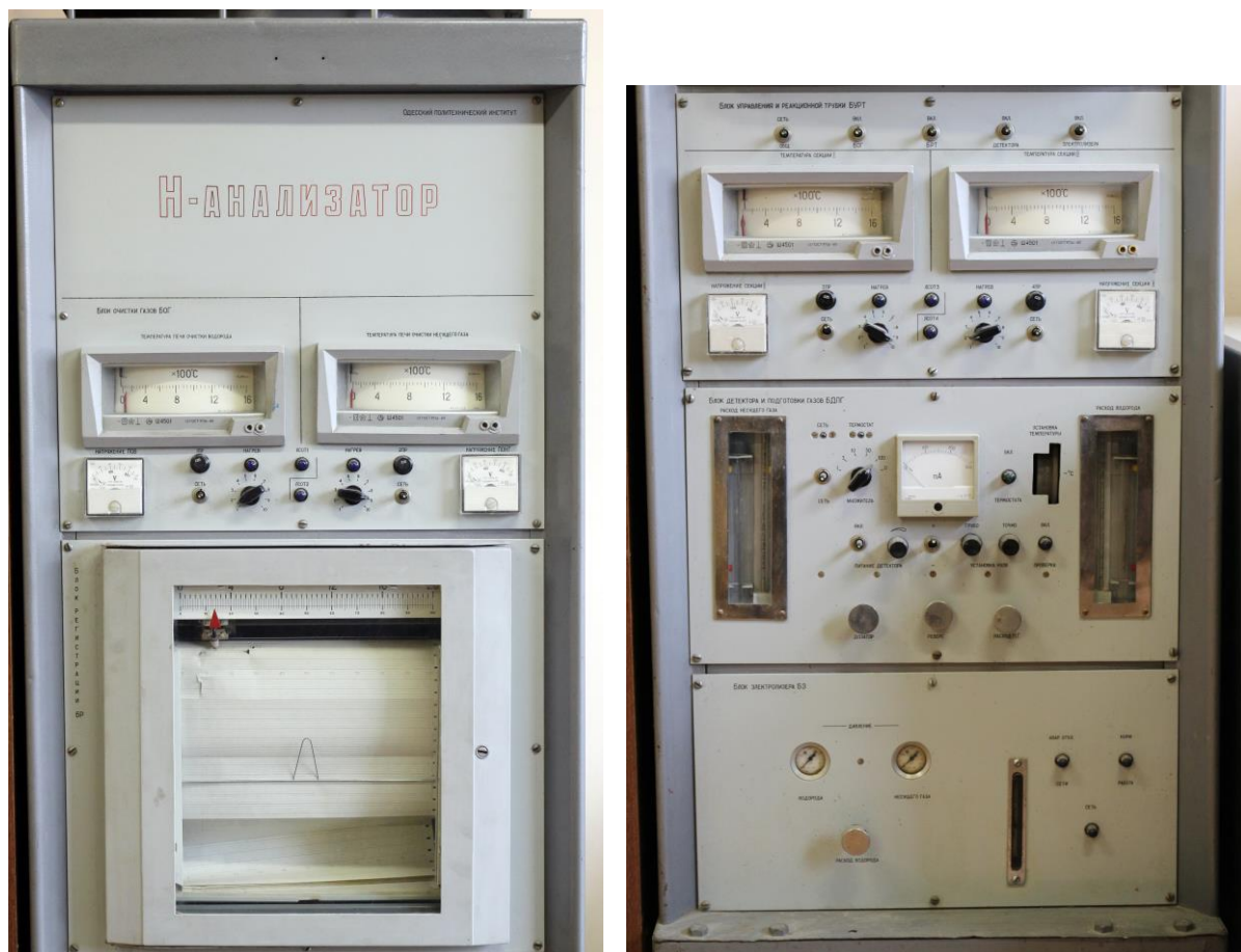
Рис. 2.13 – Загальний вигляд газоаналізатора для визначення водню
