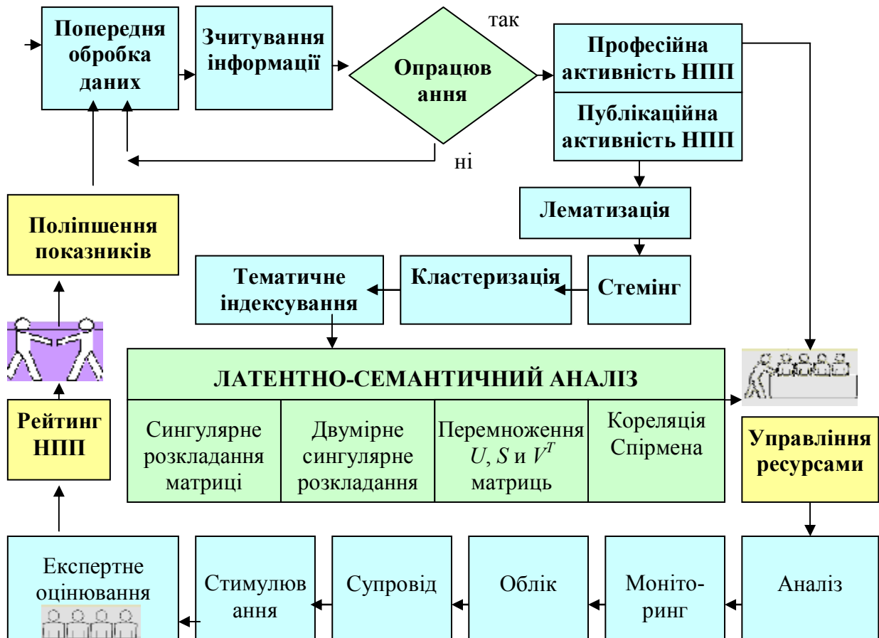
Рисунок 2.11 – Метод збору даних та перетворення інформації із наукометричних баз даних у структурований формат даних
