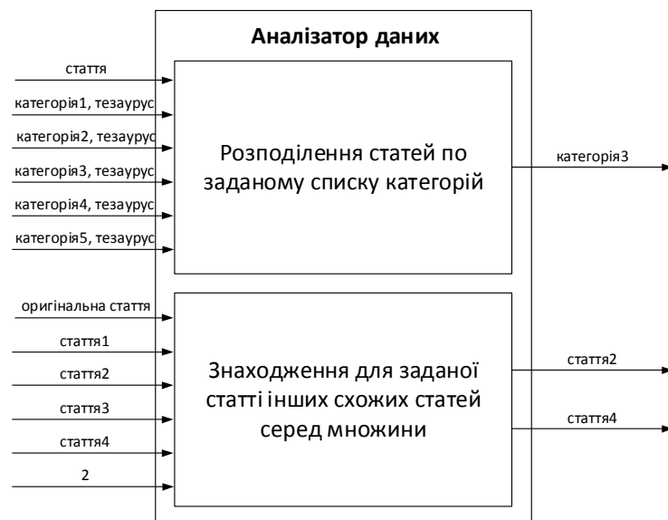
Рисунок 2.10 – Приклад даних на вході і на виході аналізатора
