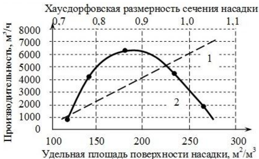
Рисунок 4 – Теоретическая (1) и реальная (2) зависимости интенсивности абсорбции от площади поверхности насадки
