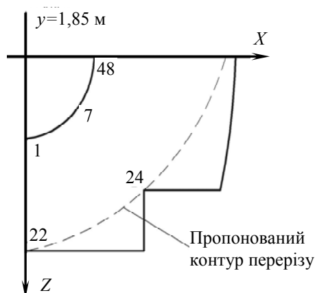
Рис. 5. Поперечний переріз верхньої траверси, що пропонується
