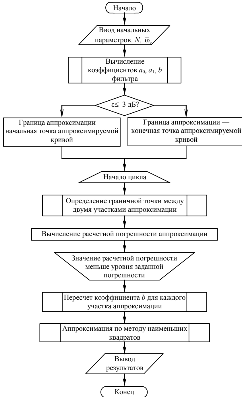
Рис. 2. Блок-схема алгоритма аппроксимации зависимости коэффициент b знаменателя передаточной функции фильтра Чебышева второго рода от частоты \bar{\omega}_c среза фильтра
