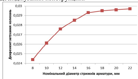
Рисунок 2 – Залежність декременту затухання коливань в зразках синтеграну від номінального діаметру анкерів закладних деталей у вигляді стрижнів арматури періодичного профілю
