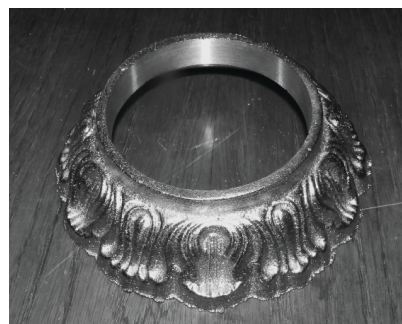
Рис. 11. Отливка «корпус часов», сплав БрО6Ц6С2х ГОСТ 614-97
