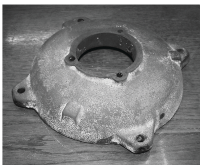
Рис. 9. Отливка «крышка», чугун СЧ 20 ГОСТ 1412-85
