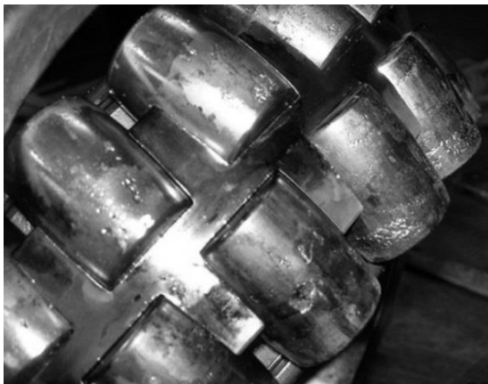
Рис. 11. Викришування тіл кочення сферичного роликотидшипника
