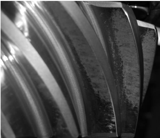
Рис. 9. Викришування робочих поверхонь зубів шестерні
