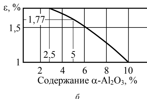
Рис. 3.16. Огневая усадка \varepsilon солекерамических стержней при температуре обжига 730 °С: а – без стабилизирующих добавок; б – с \text{Al}_2\text{O}_3 (содержание органики 15 %)
