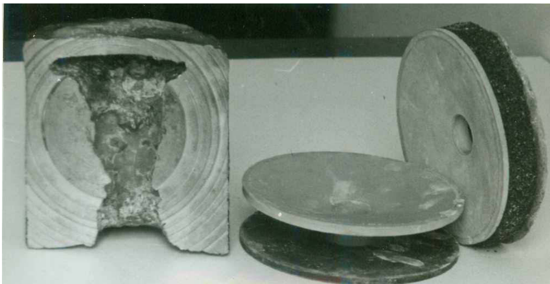
Рис. 4.36. Перегородка с экзотермической смесью и прибыль, полученная с использованием этой перегородки (нет ссылки)
