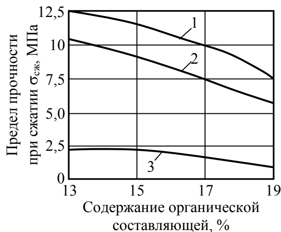
Рис. 3.23. Зависимость прочности стержней от температуры обжига (1 – 725; 2 – 650 и 3 – 550 °С) и содержания органических составляющих
