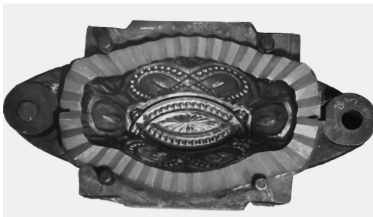
Рис. А-3. Ваза для фруктов №3063 (Киевский завод художественного стекла): a – эталон; б – отливка; в – кокиль в сборе
