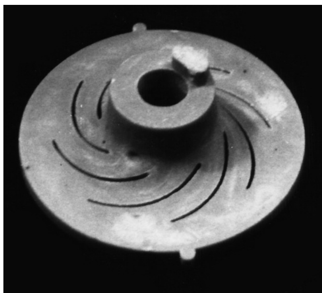
Рис. Б-17. Пресс-формы для изготовления стержней лопастных колес: a – диаметр колеса 150 мм; б – диаметр колеса 132 мм
