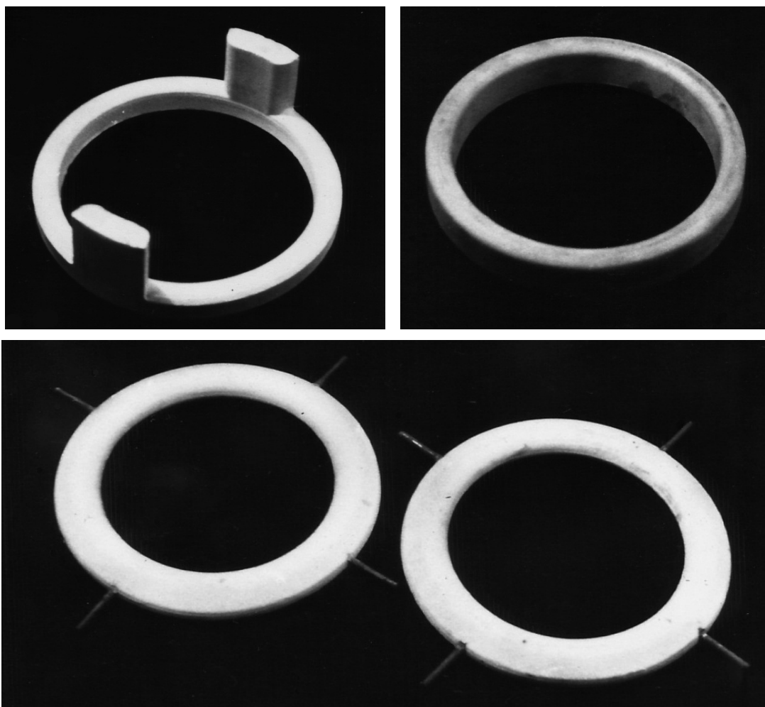
Рис. Б-11. Солекерамические стержни для охлаждаемых поршней ДВС различного конструктивного исполнения
