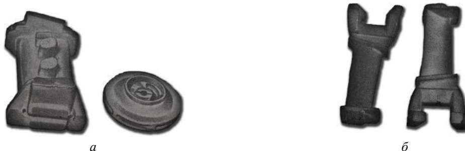
Рис.3.28. Отливки из алюминатанатрия (а) и из сплавов на основе Fe и Ni (б)
