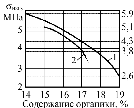
Рис. 3.17. Зависимость прочности солекерамики от количества органики при температурах обжига 730 (1) и 710 °С (2)
