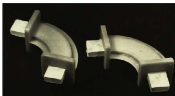
Рис. Б-15. Внешний вид моделей со стержнями для отливок волноводных элементов
