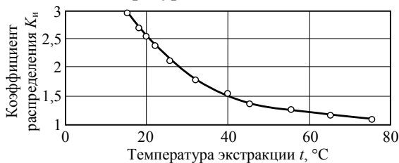
Рис. 4.2. Зависимость коэффициентов распределения K_{\text{и}} для ионола от температуры t его экстракции этанолом
