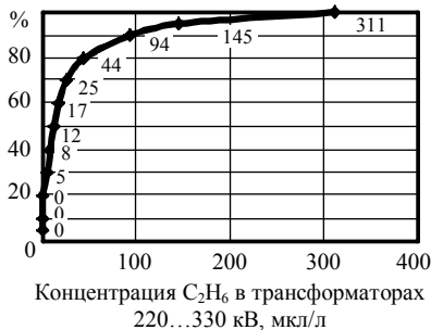
Рис. 5.5. График распределения концентраций C_2H_6 в пробах трансформаторных масел из силовых трансформаторов класса напряжения 220...330 кВ
