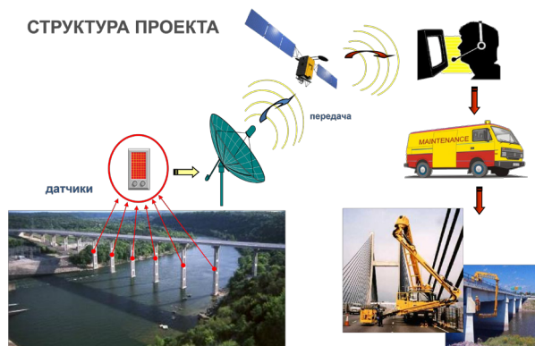
Рис. 1. Система мониторинга технического состояния мостовых конструкций, предложенная ГП «КБ Южное»
