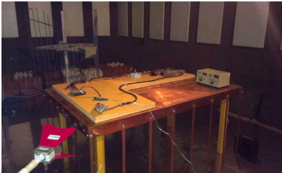
Рис. 1 – Конфигурация рабочего места при облучении ЭСУ электромагнитным полем в экранированной камере
