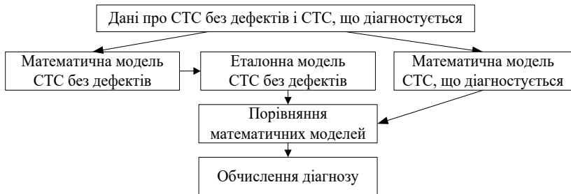
Рис. 3 – Схематичне представлення діагностики СТС за допомогою ГЕС
