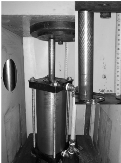
Рисунок – 2. Пружинно-гидравлический тормоз в расторможенном состоянии.
