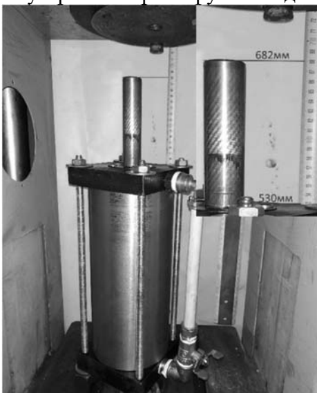
Рисунок – 3. Пружинно-гидравлический тормоз при срабатывании на 1/3 (ход штока l_1 = 40 мм) в заторможенном состоянии.
