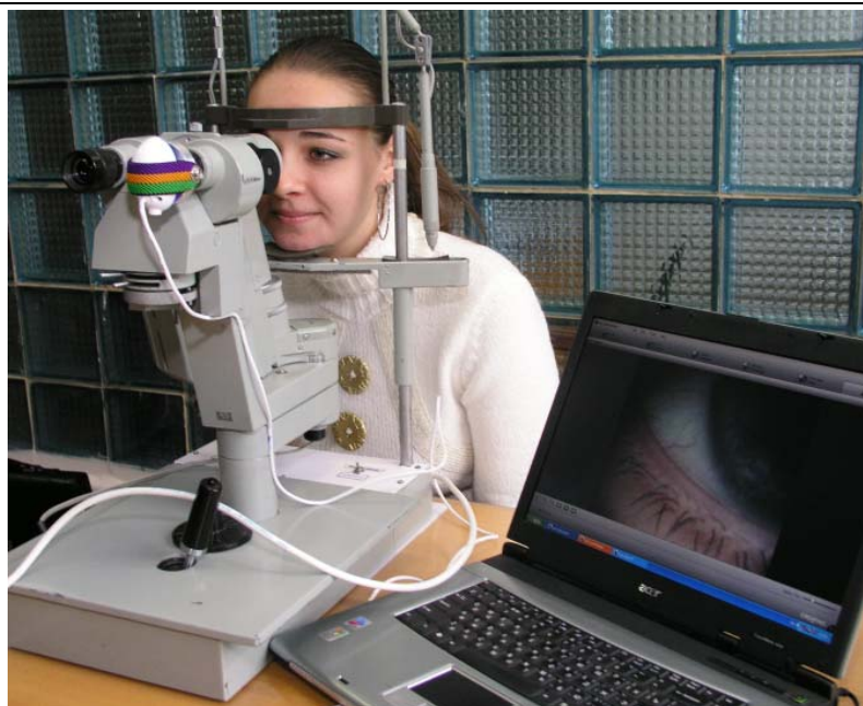
Рис. 4 Оптико-електронний діагностичний комплекс визначення структурних змін мікроциркуляції кон'юнктиви ока [11]
