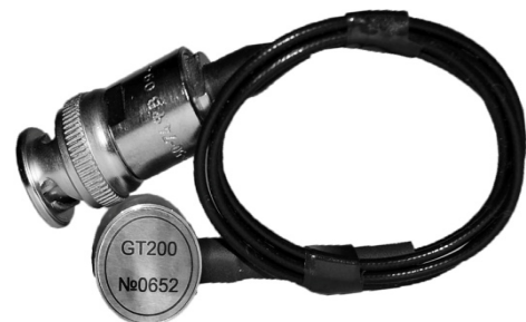
Рис. 1. Преобразователь акустической эмиссии типа GT200, рабочий диапазон частот (50-250) кГц.
