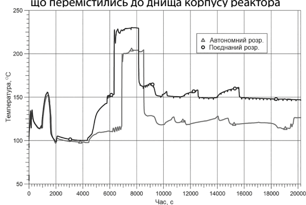
Рисунок 14 – Температура в приміщенні з течею (SGBOX1A)
