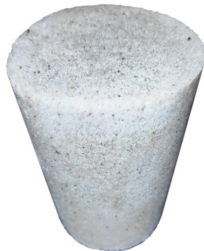
Рис. 2. Вид зразка із замороженої піщано-водяної суміші
