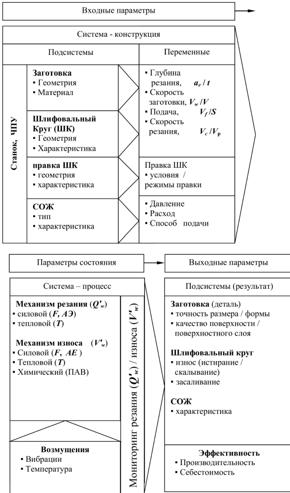
Рис. 5. Кибернетическая модель автоматизированной технологической системы шлифования: в дробных обозначениях режимных параметров указаны зарубежные [9] и отечественные обозначения
