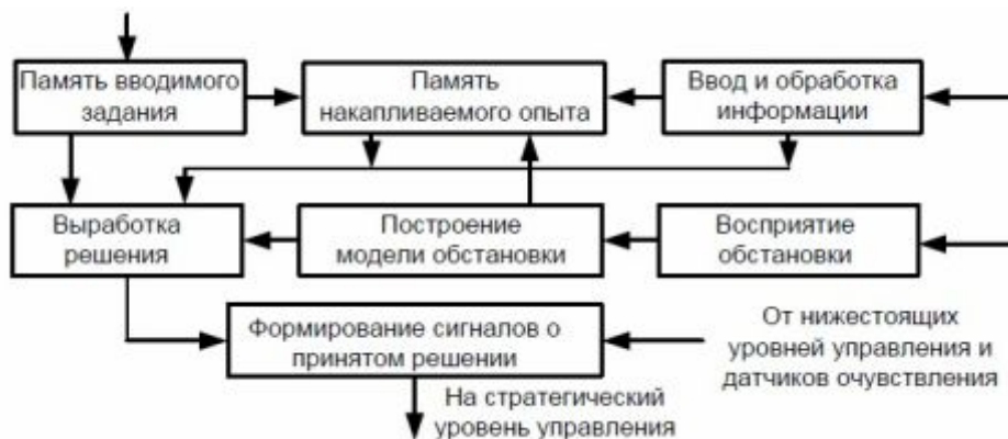
Рис. 12.3. Структура системи управління інтелектуального рівня
