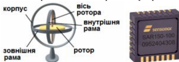
Рис. 10.8. Конструкція та зовнішній вигляд гіроскопічного датчика
