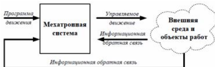
Рис. 2.1 - Функціональне уявлення мехатронної системи
