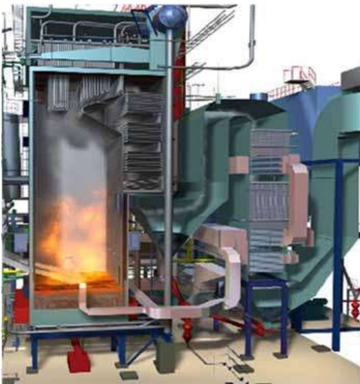
Рисунок 3.2 – Вигляд котла із топкою із циркуля-ційним киплячим шаром
