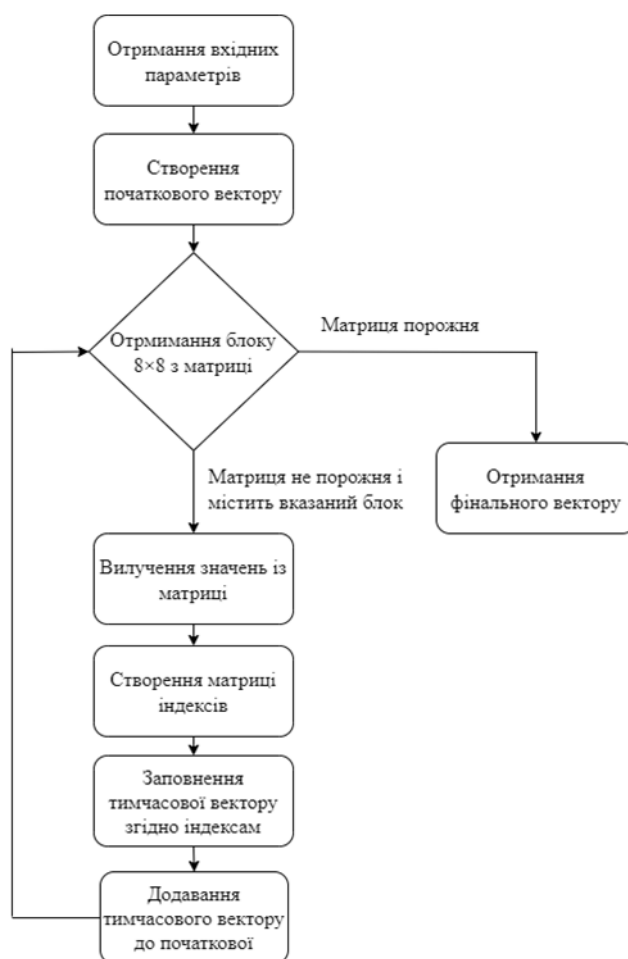
Рисунок 2.1 – Блок-схема алгоритму діагонального конвертування
