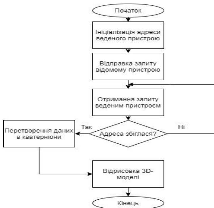
Рисунок 2.4 – Алгоритм розподілу отриманих від обробного центру кібернетичного костюма даних по осях x , y і z
