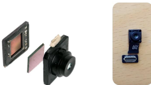
Рисунок 3.6 – Приклад модуля ІЧ-камери у розібраному вигляді
