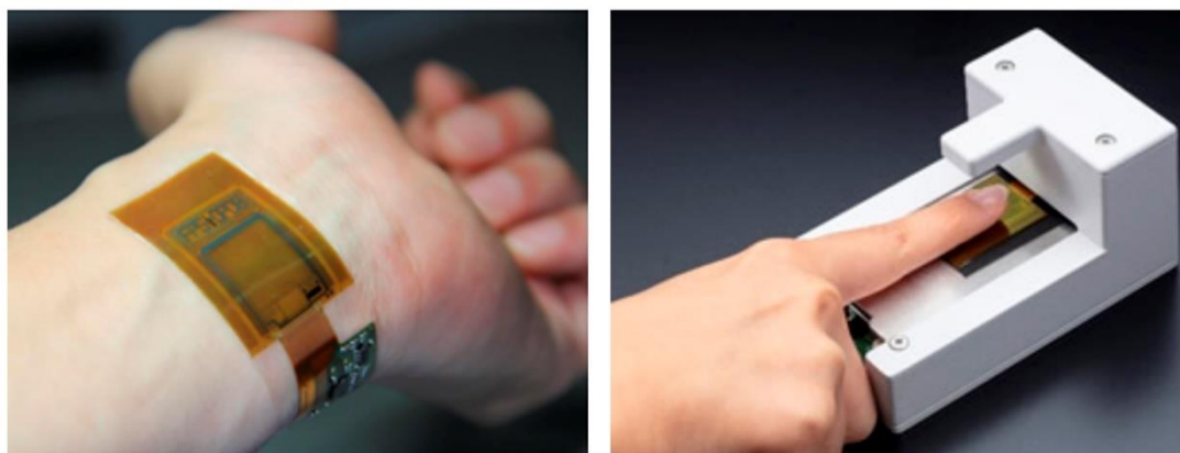
Рисунок 2.16 – Датчик зображення, що може вимірювати відбитки пальців, вени та пульсові хвилі
