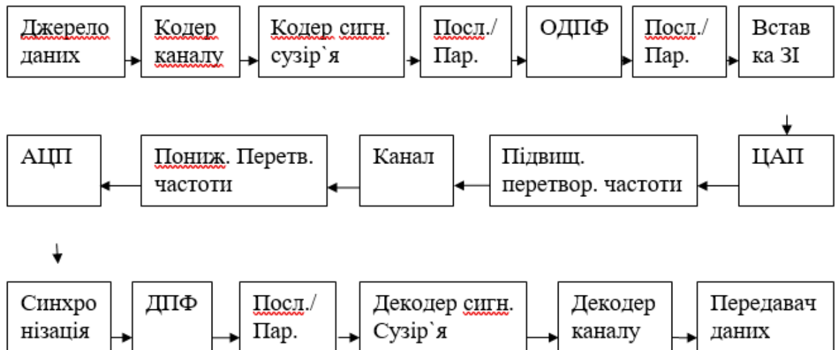
Рисунок 2.1 – Узагальнена структурна схема системи зв'язку з ортогональним частотним поділом
