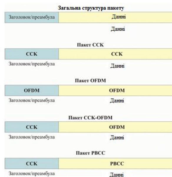
Рисунок 1.11 – Формати кадрів при використанні різного кодування
