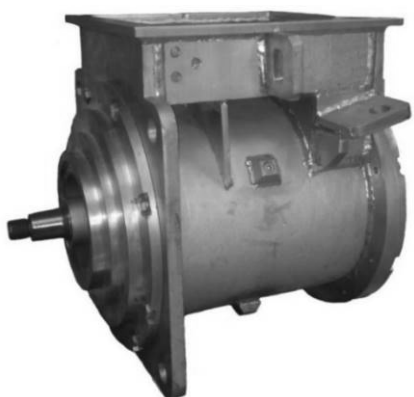
Рис. 2. Комплектный электропривод – двигатель с интегрированной системой управления
