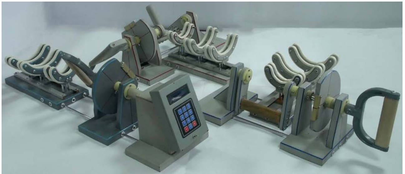
Рис. 8. Модулі діагностично-корекційного комплексу кінематики променево-зап'ясткового суглоба
