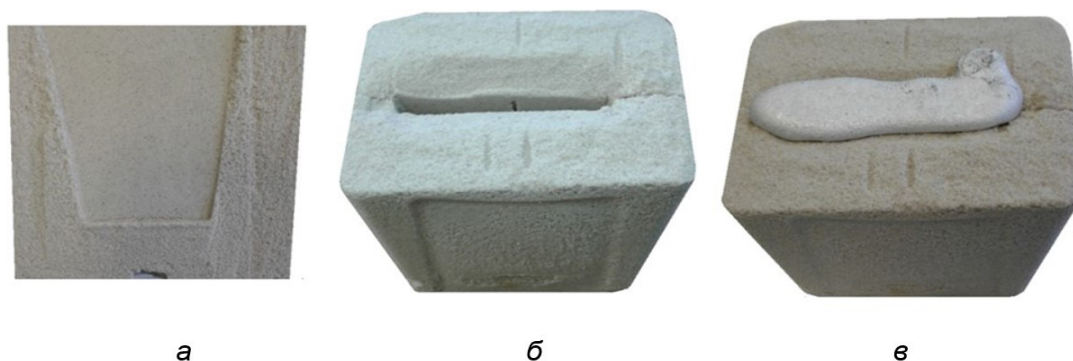
Рис. 7. Вид робочих поверхонь форми (а), форма в зборі після склеювання її половин (б), форма залита розплавом сплаву АЛ2 (в)
