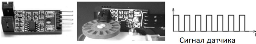
Рисунок - 6. Щілинний оптичний датчик вимірювання кута обертання колеса
