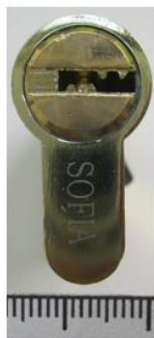
Рис. 3. Загальний вигляд торцевої сторони зведеного циліндрового механізму з ключовою шпариною з зовнішньої сторони
