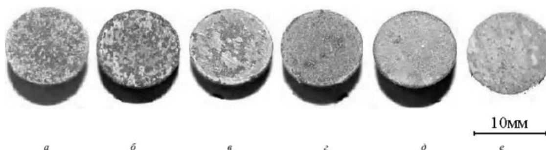
Рисунок 1 - Зовнішній вигляд монокристалічних зразків дослідних складів, випробуваних з нанесенням на поверхню розплаву \text{Na}_2\text{SO}_4 при t=950^\circ\text{C} протягом 50 годин
