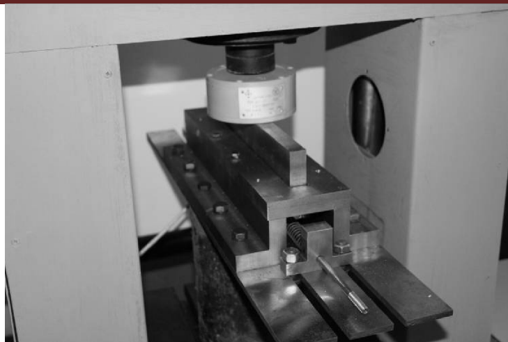
Рис. 3. Установка буферного устройства на прессе
