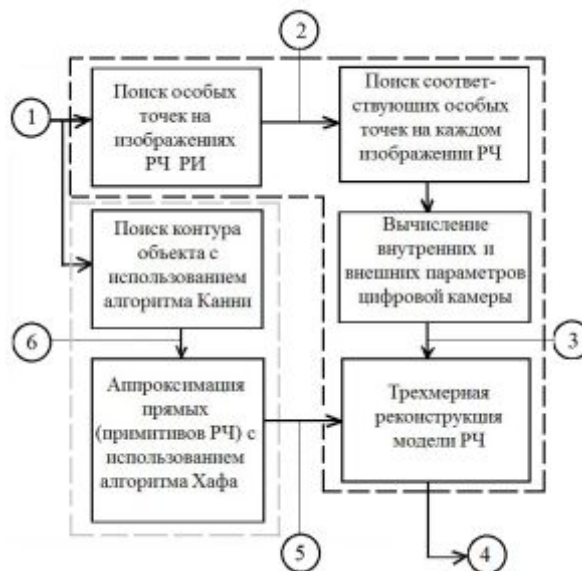
Рис. 7. Схема усовершенствованного метода трехмерной многовидовой реконструкции режущей части РИ
