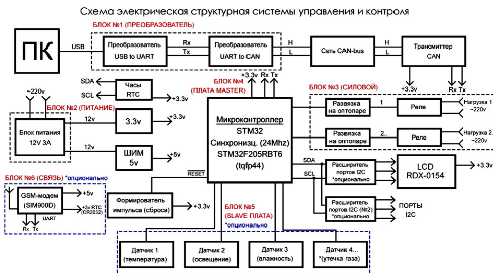
Рисунок 2 – Электрическая структурная схема аппаратных блоков SARC
