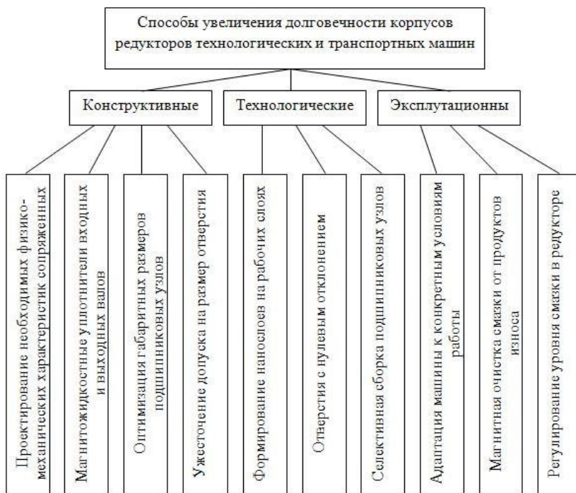
Рис. 8. Способы увеличения долговечности посадочных мест корпусов редукторов
