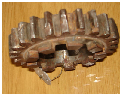
Рис.2. Поломка зубьев шестерни, не выработавшей расчетный ресурс
