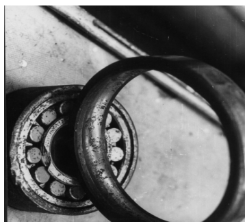
Рис.1. Преждевременный выход из строя подшипников качения
