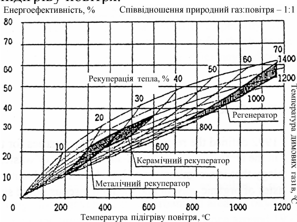
Рис. 1. Ступінь енергозбереження при використанні попереднього підігріву повітря в рекуператорах різного типу.
