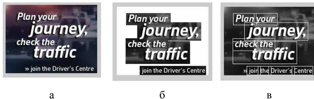
Рис. 4.8. Результат функционирования программы ИТ локализации: а – исходное изображение; б – ТО-кандидаты; в – результат классификации найденных ТО
